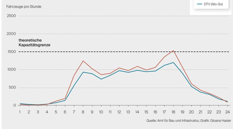
Die Grafik zeigt, wie sich der Verkehr in Schaan Richtung Rheinbrücke stündlich entwickelt. DTV entspricht dem durchschnittlichen Tagesverkehr (Montag bis Sonntag). DWV entspricht dem durchschnittlichen Werktagsverkehr (Montag bis Freitag).
