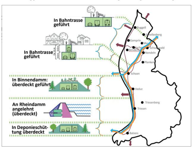
Um die heute stark beanspruchten Hauptstrassen (rot markiert) zu entlastsen, schlagen die Initianten vor, die Bahnstrecke und Hauptverkehrsrouten in einem unterirdischen Korridor durchs Land zu führen (orange und blau). (Illustration: ZVG)
